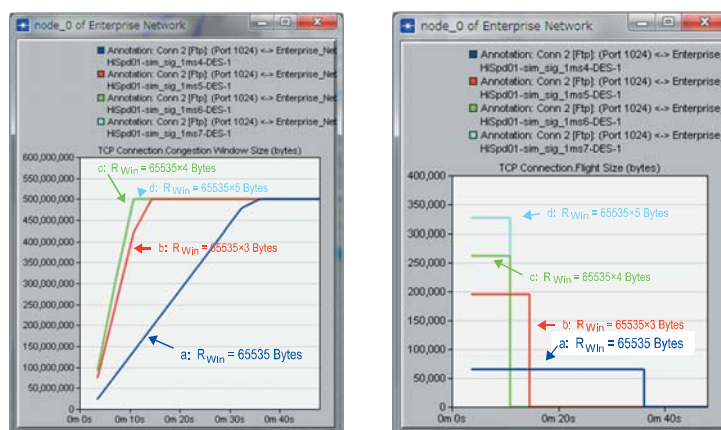
図 8 : 輻輳ウィンドウとフライト・ウィンドウ・サイズの変化 ( d_{01} = 1\text{ ms} )
