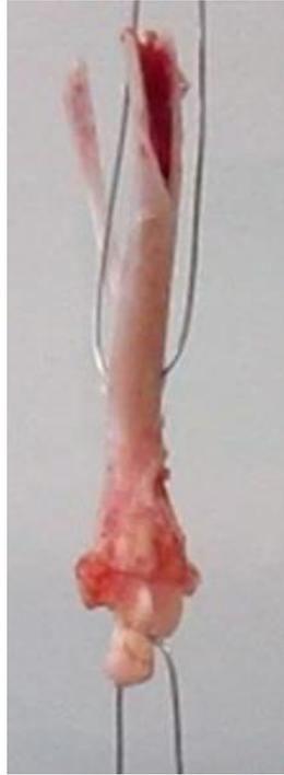
図 3-4 引張試験機への距腿靭帯の取付
