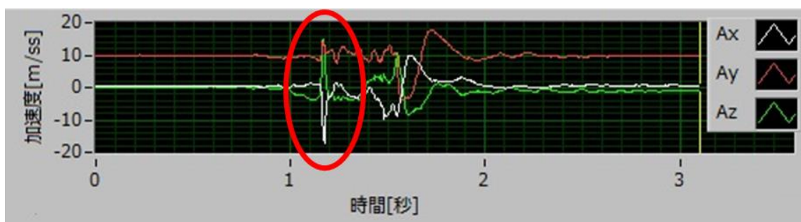
図 16 慣性センサ①から得られた加速度波形の典型例
