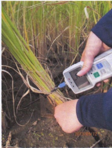
図 6-5 押し倒し抵抗値測定の様子
